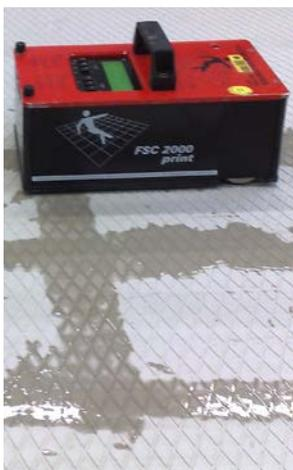
Влажный отпечаток на бетоне с узором алмаз GIAN1 испытывается прибором FSC 2000.
