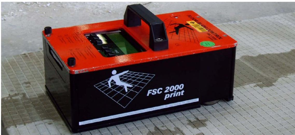
FSC 2000 - это управляемое устройство для измерения фрикционного сопротивления в различном положении.
