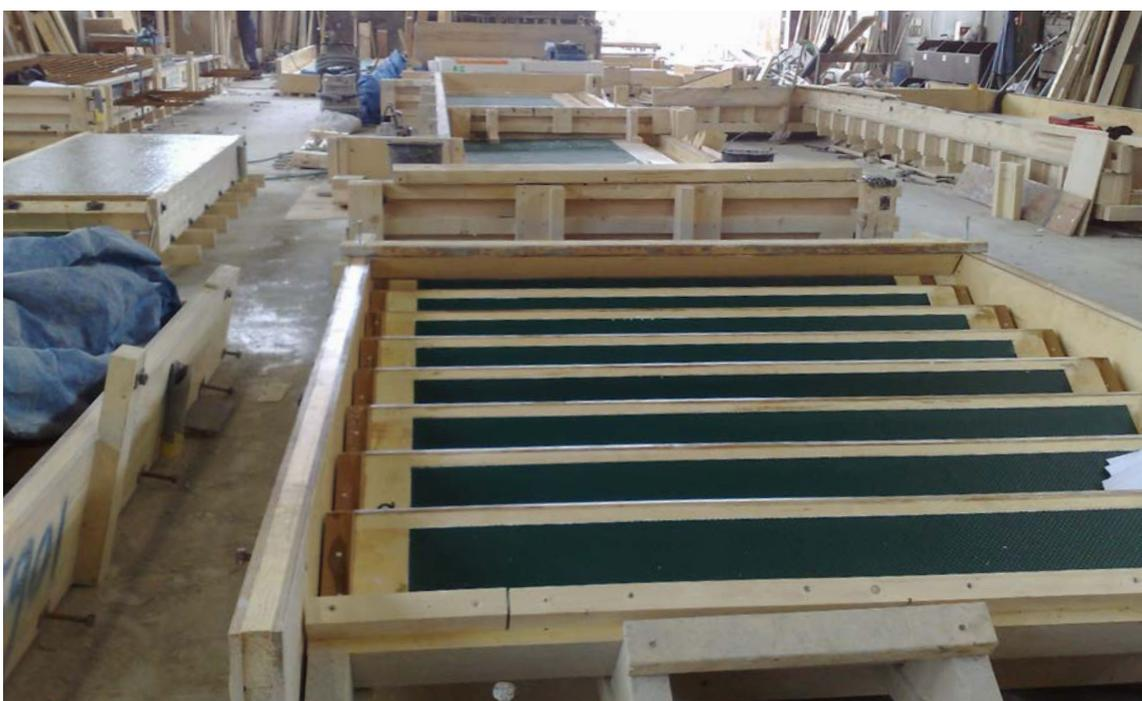
Пример внешнего вида формы для бетона с вклеенным в нее текстурным матом **GIAN**
