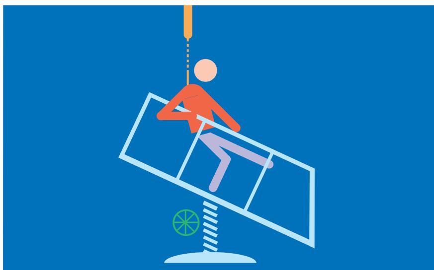
Во время теста наклоняется установка, которая может находиться только в лаборатории, градиент наклона увеличивается. Чем больше угол наклона в момент начала скольжения, тем выше будет значение R.
